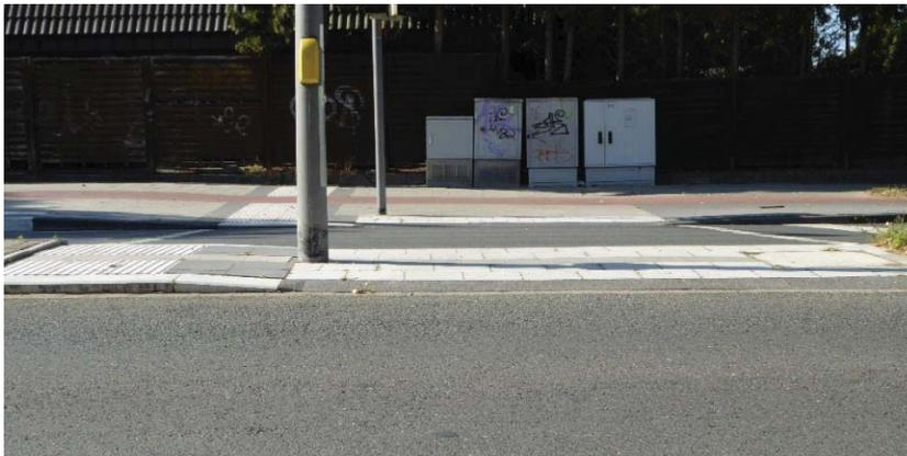
Abb. 26: Getrennte Querungsstelle mit differenzierter Bordhöhe und Anforderungstaster (Beispiel)
