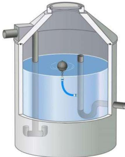
**Abbildung 5-6: Beispiel eines unterirdischen Regenspeichers** [mall Umweltsysteme]
