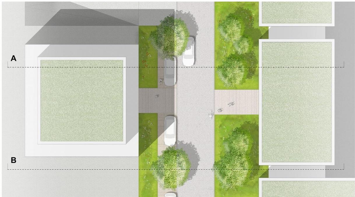
Abbildung: Schematische Darstellung des 9 m breiten Querschnittes des Straßenraumes (GREENBOX, 10/2022)
