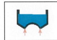
Dieses System stellt eine Kombination der Kraftwirkung eines Hängebodens mit der eines nach oben gewölbten Bodens dar. Auf den Auflagern wirken nur noch Druckkräfte, die gesamte Materialbeanspruchung ist gering. Anfänglich werden Intzebehälter nur aus vernieteten Eisenblechen hergestellt, mit der stetigen Verbesserung der Produktqualitäten dann auch aus Beton, siehe dazu die Wirkung der Druckkräfte im Auflagerring.
