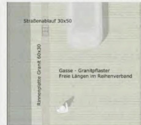
Detail Aufsicht Beläge - Gasse M 1:50
