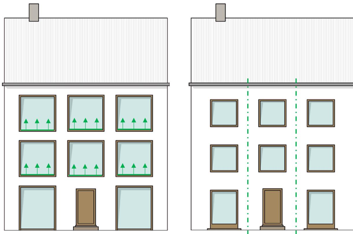
*Der Fensteranteil der Fassade kann bereits erster Ideengeber für die Herangehensweise bei der Fassadenbeleuchtung sein.*
