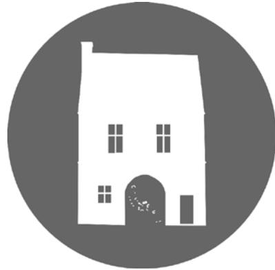
Beispiel für eine Gestaltung der Gobo-Schablone. Das Gebäude wird in seinem Umriss erfasst. Die Fenster, das Tor und die Leuchtreklame werden ausgelassen. Dafür wird auf der Tor die Draufsicht der "Historischen Meile" projiziert.
