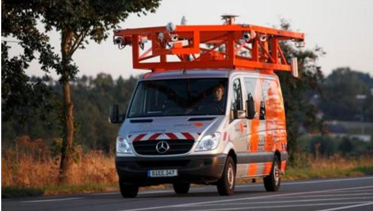
Abb. 4: kinematisches Messfahrzeug eagle eye XL1
