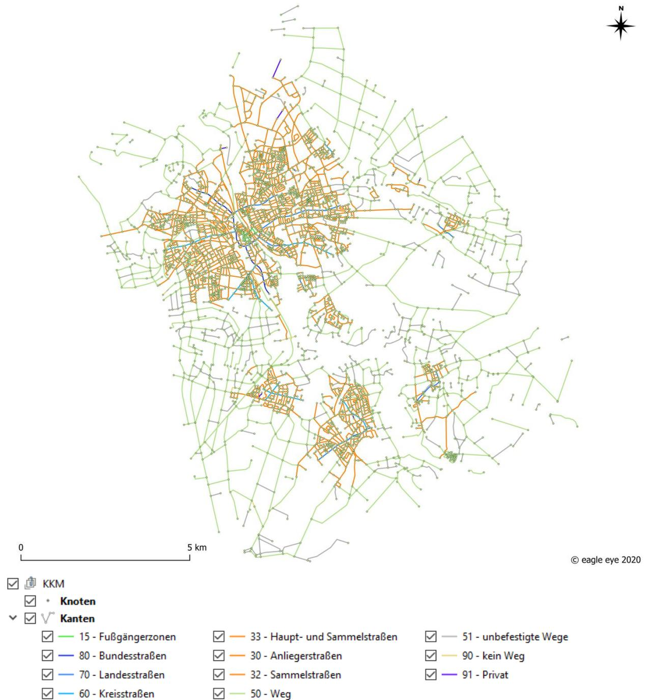
Abb. 2: Knoten- und Kantenmodell
