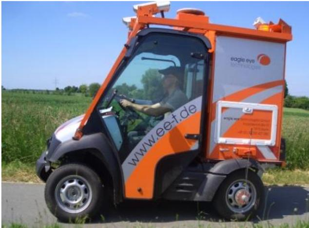
können, z.B. wegen zu geringer Breiten oder Höhen, kommt das Schmalspurfahrzeug „eagle eye XS“ zum Einsatz. Es wurde dieselbe Systemkonfiguration wie bei dem großen Fahrzeug realisiert. Es können Messungen mit identischer Qualität durchgeführt werden, da ebenfalls die gleichen qualitativ hochwertigen Hardwarekomponenten und die identische selbstentwickelte Steuerung und Software hier auf minimalem Raum zum Einsatz kommt.
