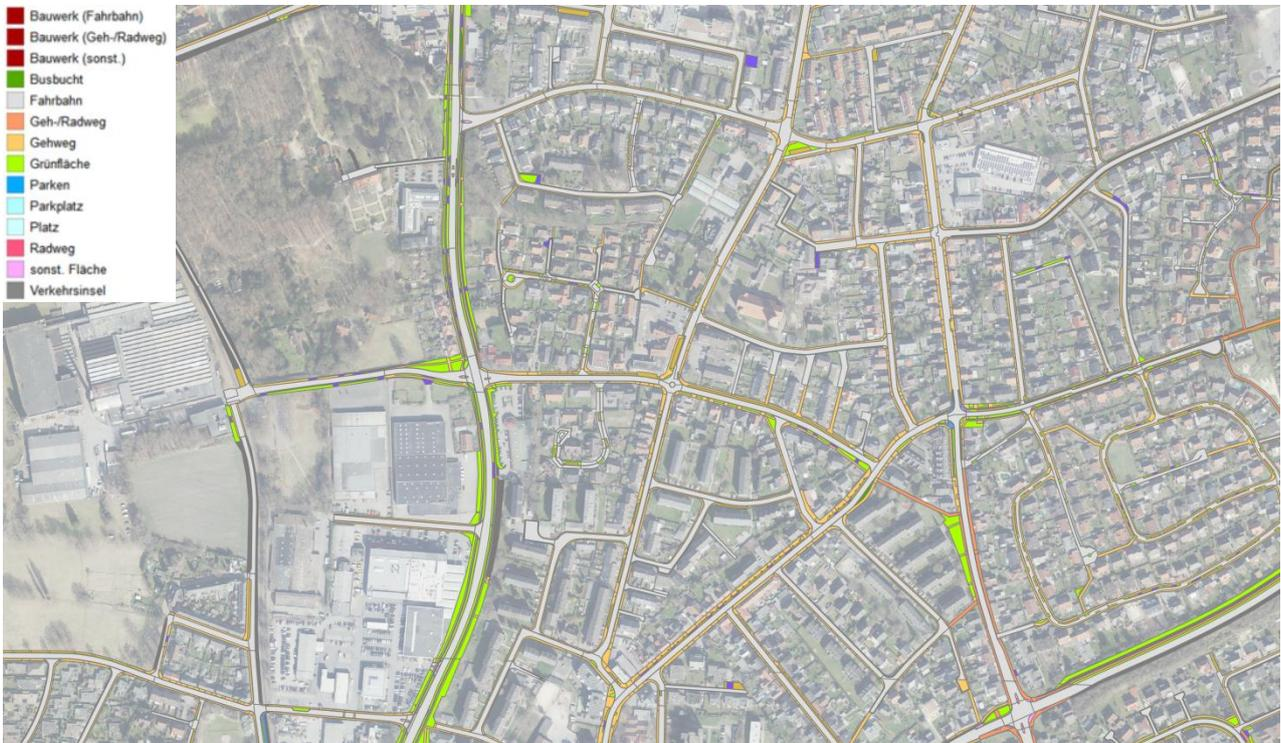
Abb. 9: Beispiel einer thematischen Karte (Einfärbung nach Funktionen)
