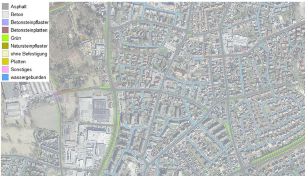
Abb. 10: Beispiel einer thematischen Karte (Einfärbung nach Deckschichtarten)
