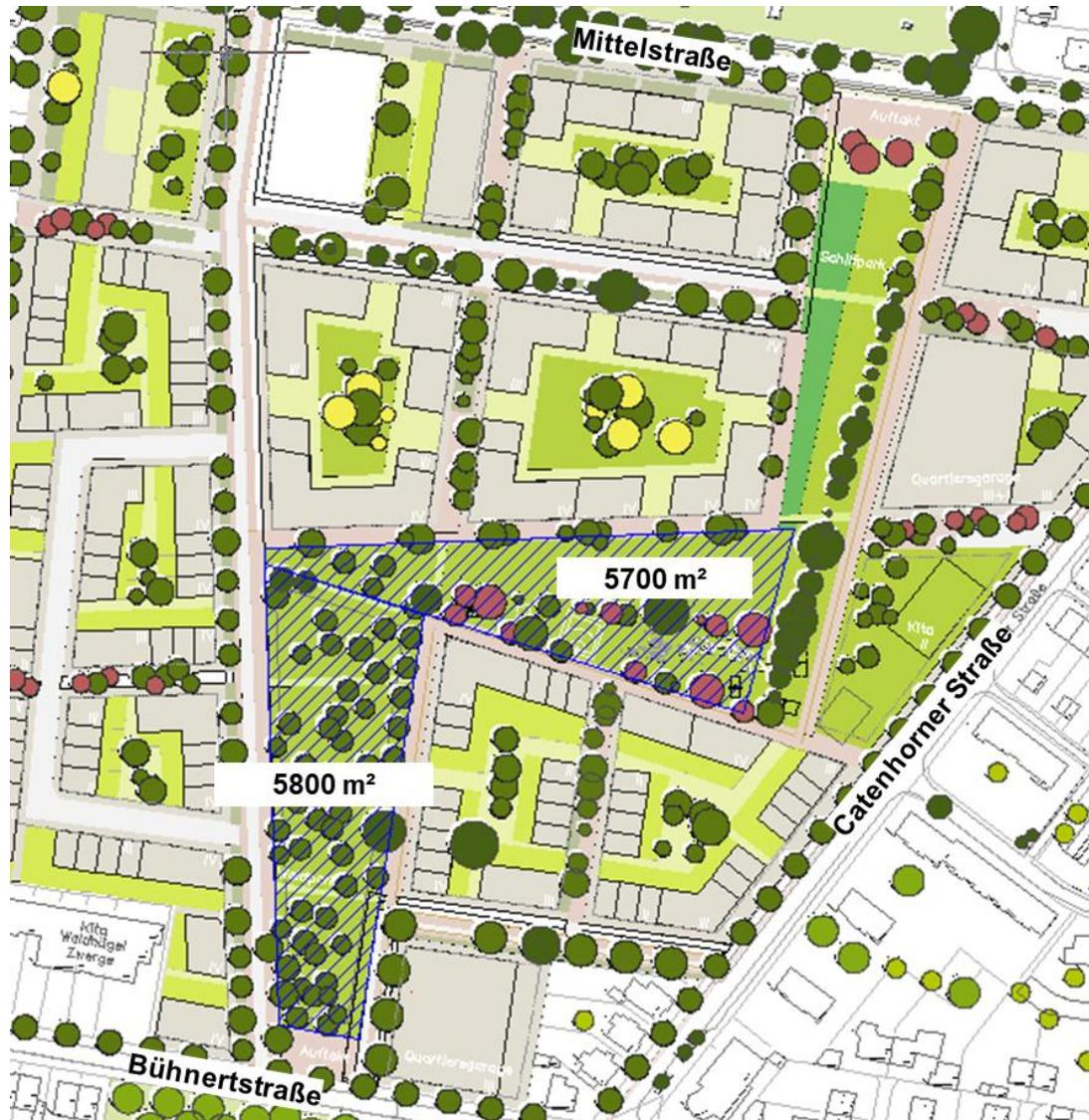
Abbildung 3.7: Mögliche Flächenpotenziale für die Nutzung von Geothermie im betrachteten Gebiet
