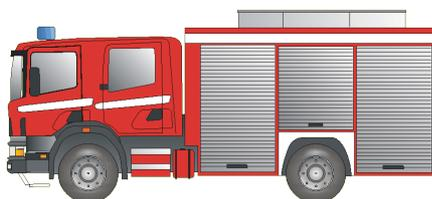
Fahrzeug mit feuerwehrtechnischer Beladung und ggf. Wasservorrat. Es wird primär zur Brandbekämpfung eingesetzt, kann aber auch zur Technischen Hilfeleistung herangezogen werden. Mitgeführte tragbare Leitern (Steckleiter und Schiebeler) ermöglichen die Menschenrettung aus Gebäuden bis zur mittleren Höhe. Löschgruppenfahrzeuge haben eine eingebaute Feuerlöschkreiselpumpe oder führen eine oder mehrere Tragkraftspritzen mit sich.
