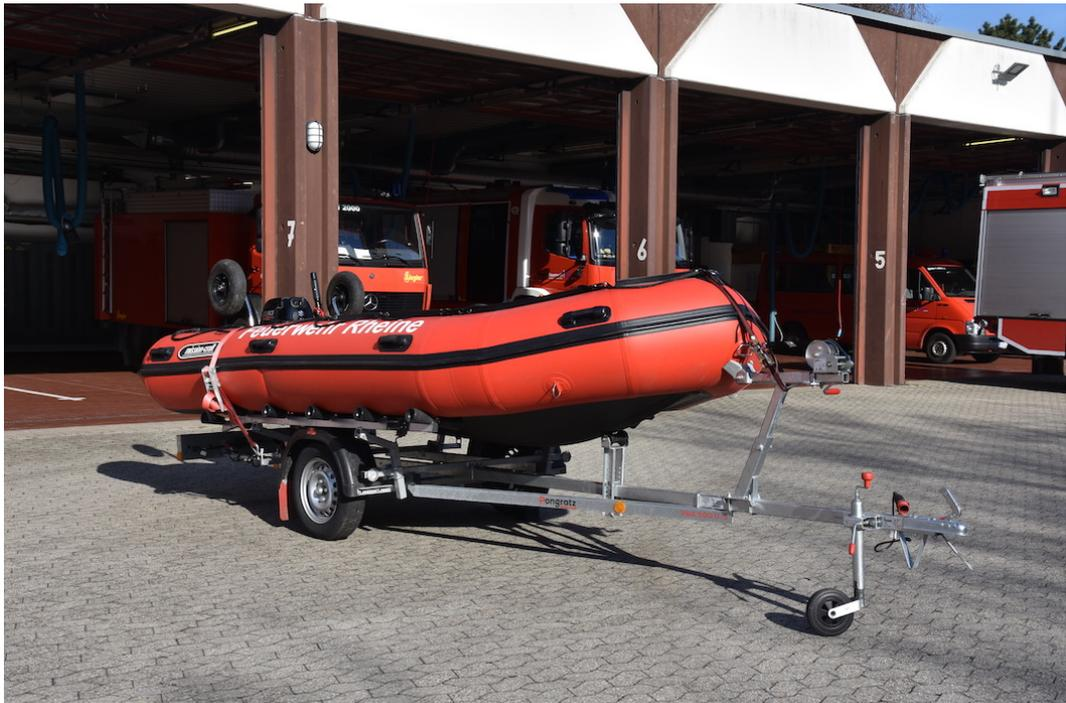
Abb. 7.4-12: LZ links der Ems: Rettungsboot ohne Propellerschutz
