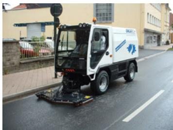
Fahrzeug zur Beseitigung von Ölspuren auf Fahrbahnoberflächen. Es wird mit speziellen Rotordüsen ein Wassergemisch unter Hochdruck auf die zu reinigende Fläche aufgebracht. Im gleichen Arbeitsgang wird durch ein Zweikammer-Vakuumsystem der abgelöste Schmutz mit dem Wasser abgesaugt. Auch Wände und
