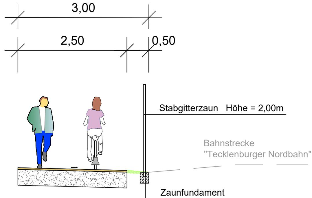
4 cm wassergebundene Deckschicht
