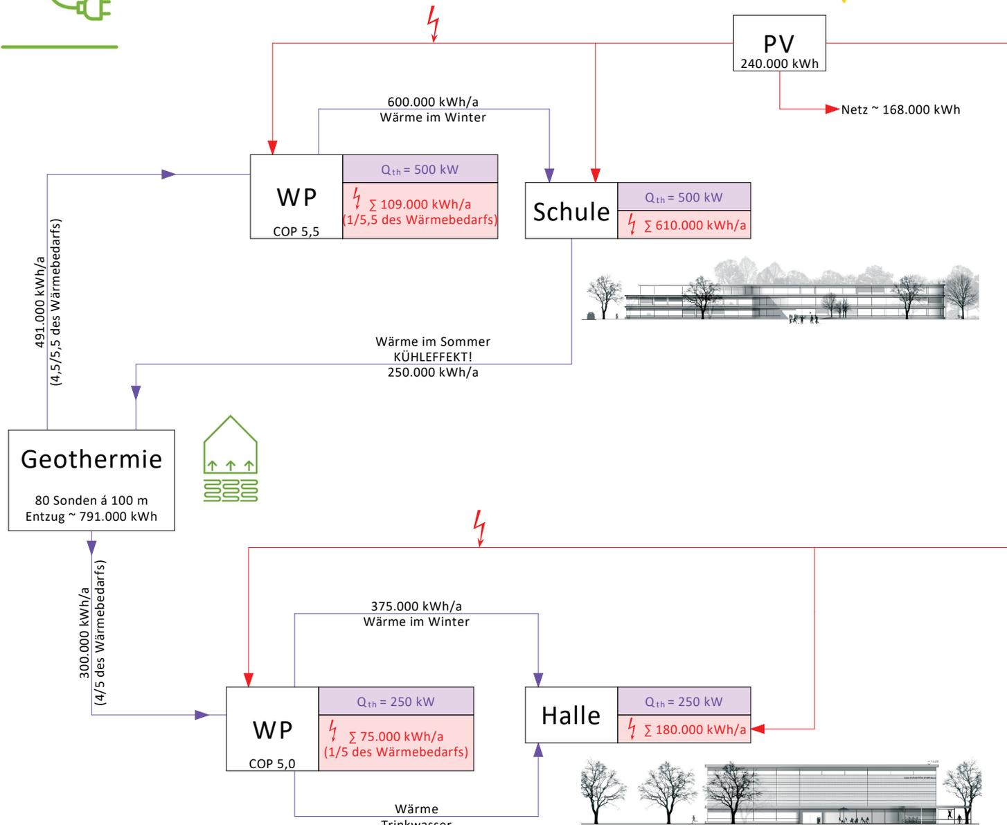
**monovalenter Wärmepumpenbetrieb mit einer Erdsondenanlage**
