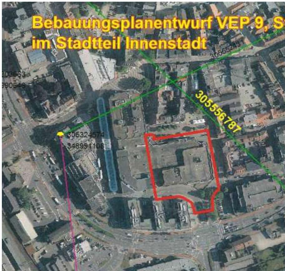
*Die farbigen Linien verstehen sich als Punkt-zu-Punkt-Richtfunkverbindungen der Telefónica Germany GmbH & Co. OHG. Das Plangebiet ist im Bild mit einer dicken roten Linie eingezeichnet. Die Linie in Magenta hat keine Relevanz für Sie.*
