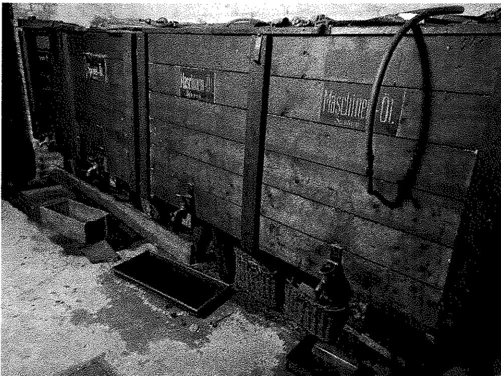
Abbildung 1: Öllagerbehälter aus Holz im Öllager.
