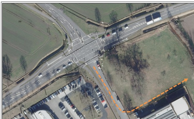
Abbildung: Erschließung über LSA-gesteuerten Knotenpunkt „Russenweg/Morsestraße“
