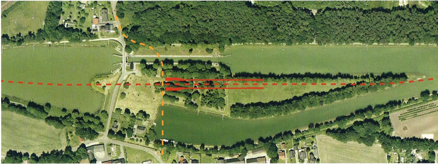
Der Standort der neuen Schleuse Rodde verschiebt sich in Richtung oberer Vorhafen auf die heutige „Kanalinsel“ zwischen der vorhandenen und bereits verfüllten alten Kleinen Schleuse. Die Straßenführung muss entsprechend angepasst werden. Am Schleusenstandort Rodde ist der Baubeginn im Jahr 2015 vorgesehen. Die Arbeiten werden mit fünf bis sechs Jahren kalkuliert. Die neue Schleuse wird dann voraussichtlich 2019 für die Schifffahrt freigegeben.
